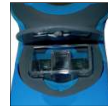
Cuvet in Tester plaatsen
