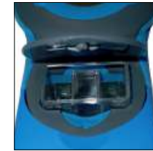
Cuvet in Tester plaatsen
