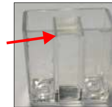
Kuvette mit 3.3 ml Wasser
